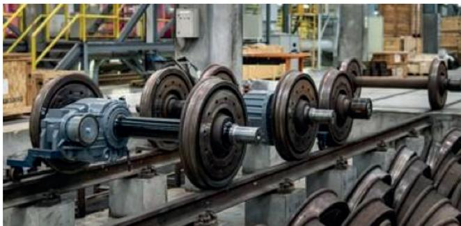
Ejemplo de eje de rueda de tren con reductora montada en fábrica, <https://www.shutterstock.com/es/search/mantenimiento-ferroviario>
