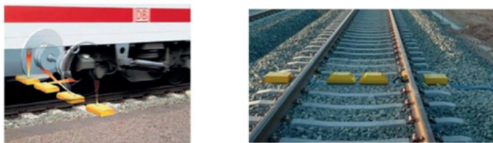
Detector de Cajas Calientes
