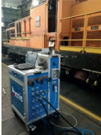
Equipo para pruebas de frenos de aire, <https://www.sim-impex.com/es/product/equipo-de-pruebas-de-freno-portatil/>
